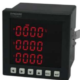
Sync-D 系列多功能表是高性能的监测仪表, 可选高清中文 LCD 显示和超亮中文 LED 显示, 用于配电系统的测量监视与控制, 可真有效值测量三相电压、三相电流、有功功率、无功功率、视在功率、功率因数、频率、谐波, 正反向有功 / 无功电能计量。具有 RS-485 通讯、开关量输入、越限报警、遥控输出、模拟量变送输出和电能脉冲输出等功能。
